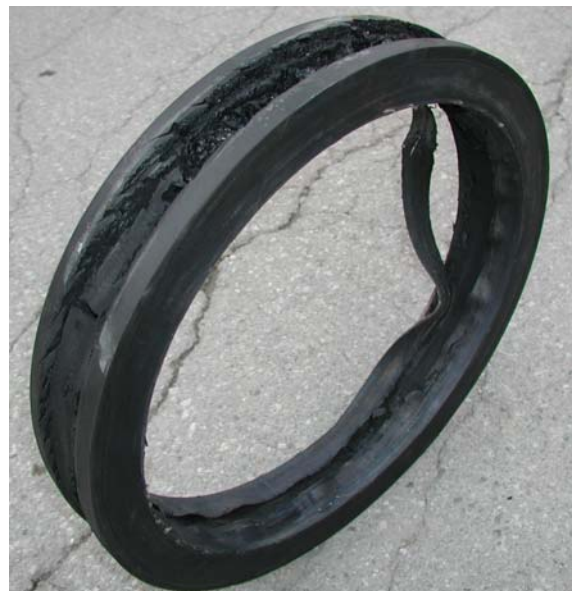
Thermisch zerstörter Seilbahneinlagering mit Rutschspuren
