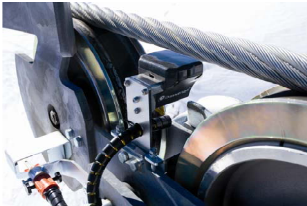
© Doppelmayr Seilbahnen GmbH - Seilbahneinlagering in geschlossener Ausführung mit Gewebeeinlage
