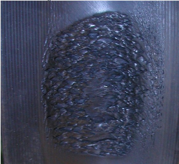
Beschädigung durch eine blockierte Rolle
