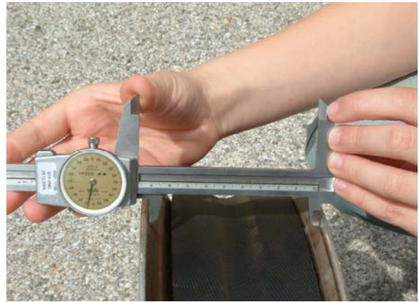
Abstand zwischen den Bordscheiben ist zu überprüfen
