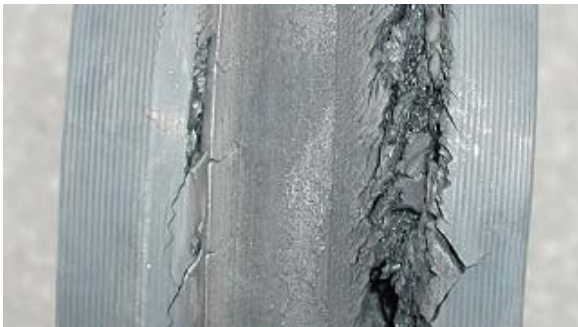
Thermische Zerstörung im fortgeschrittenen Stadium
