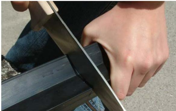
Ablängen eines Seilbahneinlageprofils
